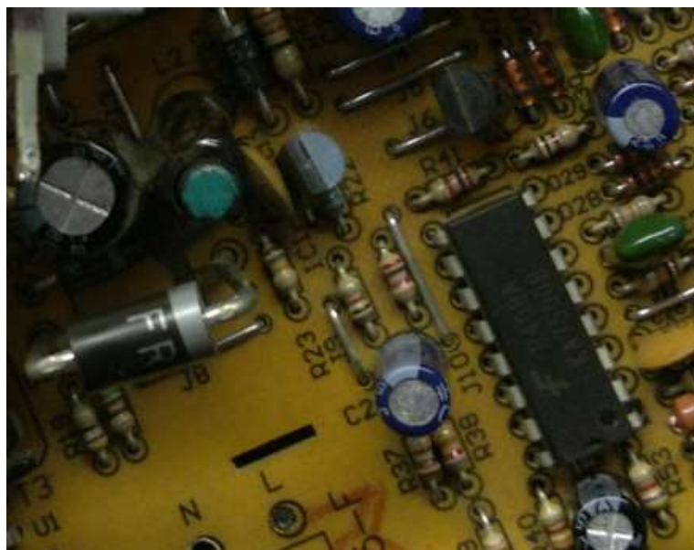
Рис.5. Стабилизатор, выполненный на микросхеме TL494 (в правой части)
